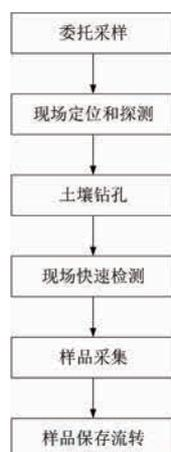
图 4.1-2 土壤采样流程图
